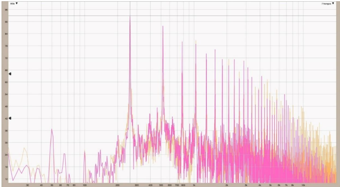
45. ábra: A natúrkürt rezonancia spektrumai hangzó C hang fortissimo esetén ► B-basso ► C-alto
