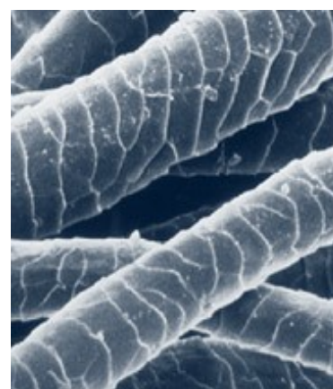
38. ábra Gyapjú pikkelyes felszínének elektronmikroszkópos képe.
