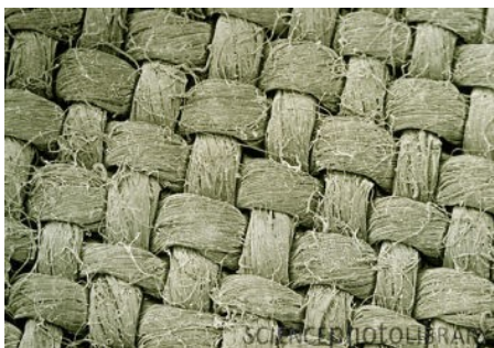
35. ábra Vászonszővésű lenszövet elektronmikroszkópos képe.
